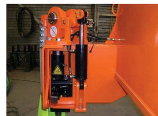
**Abbildung 13:** Spreader mit hydraulischen Stoßdämpfern (Quelle: VDL Containersystemen b.v.)
