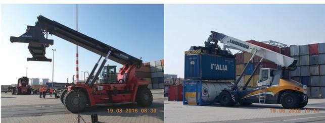
Abbildungen 1 und 2: Reachstacker mit Dieselantrieb (links) und mit hydrostatischem Antrieb (rechts).
